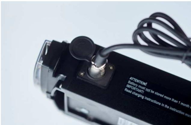
Connexion de recharge de la batterie des vélos cargos triporteurs à assistance électrique
