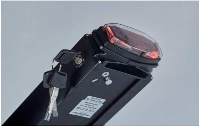
Batterie verrouillable des vélos cargos triporteurs à assistance électrique
